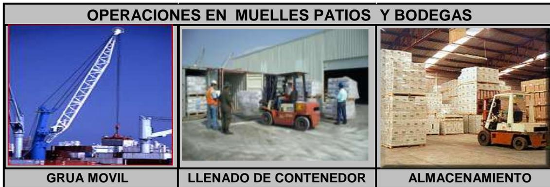
En la primera la grúa móvil de tierra descargando y cargando contenedores de un buque portacontenedores, el cual no se encuentra atracado en el muelle de las grúas pórticos.
