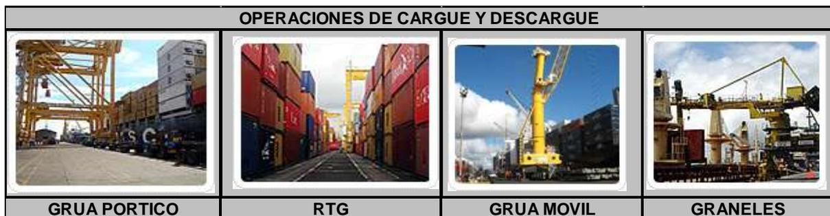
En tercera imagen se observa una grúa móvil realizando cargue y descargue de contenedores sobre el muelle multipropósitos del puerto.
